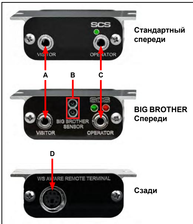
Рисунок 4. Функции и компоненты выносных портов
