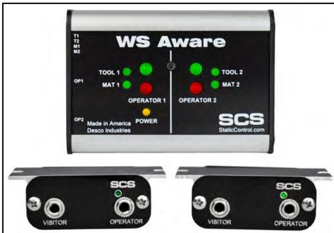
Рисунок 1. Монитор SCS 770061 WS Aware со стандартными выносными портами
